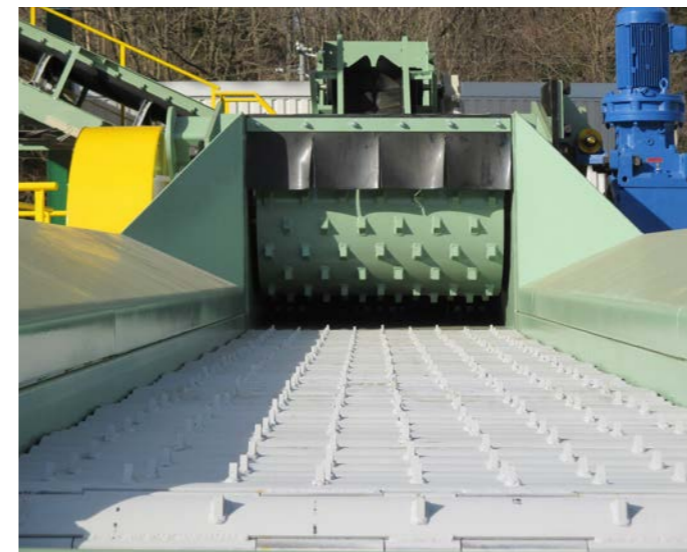
■ フィードコンベヤ & フィードローラー
